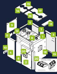
BOILER ASSEMBLY EXPLODED VIEW
